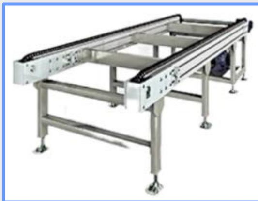
チェーンをモーターに取付けたスプロケットで駆動させて荷物を搬送するコンベヤ
